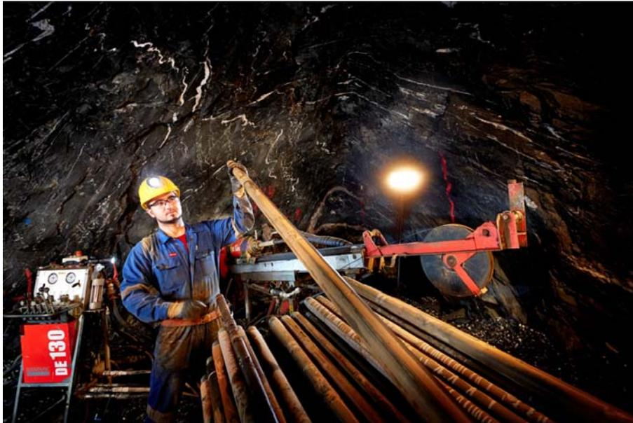
Abb. 2: Seilkernbohrmaschine im Scheelitbergbau Mittersill
