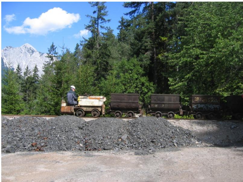
Abb. 3: Förderung Ankerschlag mit elektrischer Grubenbahn, Quelle: M. Schatz 2012
